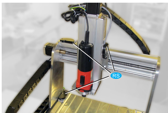
Bild 30: Position der Referenzschalter an der Maschine
