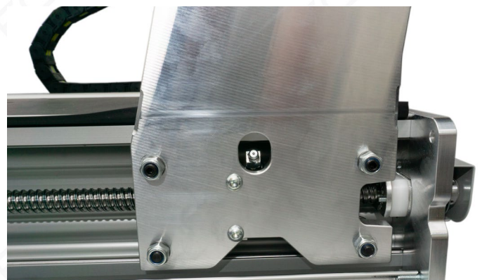
Bild 12: Rechte Portalwange mit Nippel durch Bohrung.
