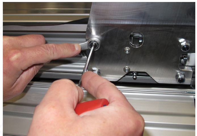
Bild 21: Einstellen der Führungsrollen
