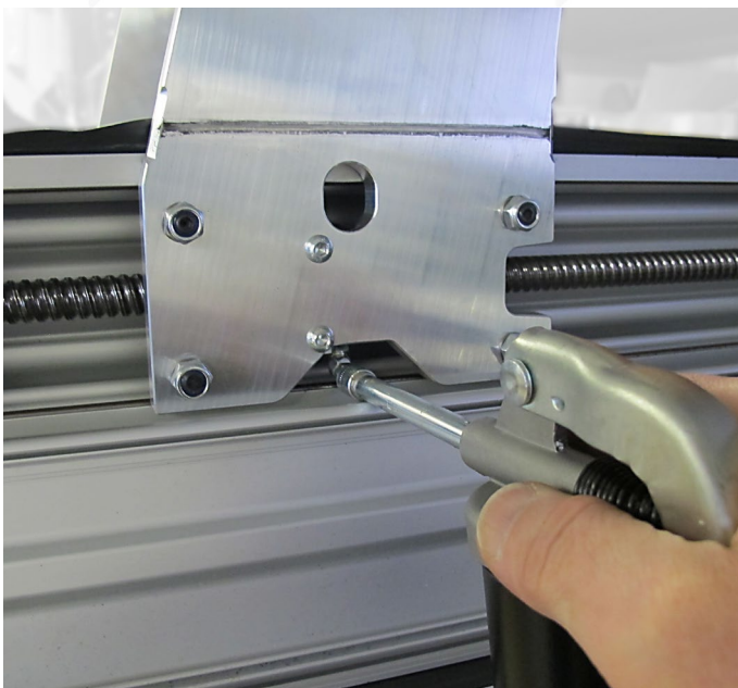
Bild 46: Abschmieren der Y-Achse rechts
