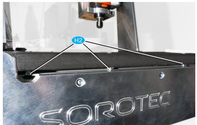
Bild 42: Noch nicht richtig ausgerichtete Hammermuttern
