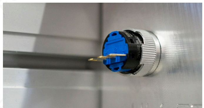
Bild 29: Montage des Notaus-Schalters, Sicht von hinten
