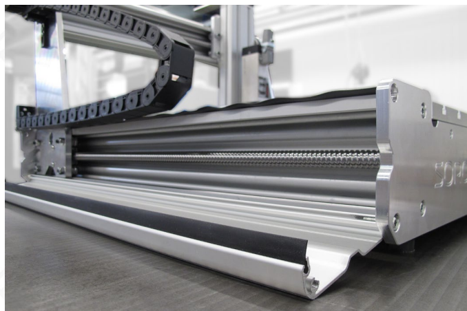
Bild 28: Zur Wartung der Spindeln lassen sich die Seitenabdeckungen nach Entfernen der oberen Schrauben einfach aufklappen.
