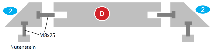
Bild 4: Vormontage der Versteifungen
