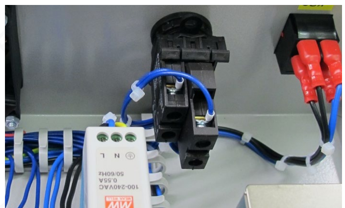
Bild 4: Baugruppe aus Taste, LED-Element, Kontaktelement
