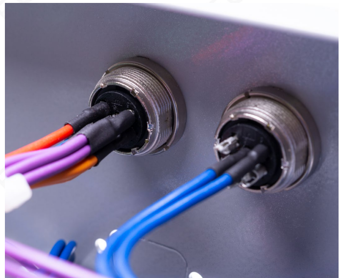
Bild 16: Jeder Pin einzeln mit Schrumpfschlauch isoliert
