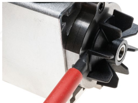
Bild 4: Abhebeln des Lüferrades
