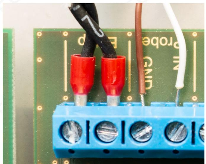
Bild 20: Anschluss des Nothalt-Schalters an „Estop“ und des Werkzeuflängensensors an „Probe“
