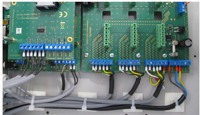
Bild 23: Angeschlossene Leitungen für Schrittmotoren, Endschalter und Notaus.
