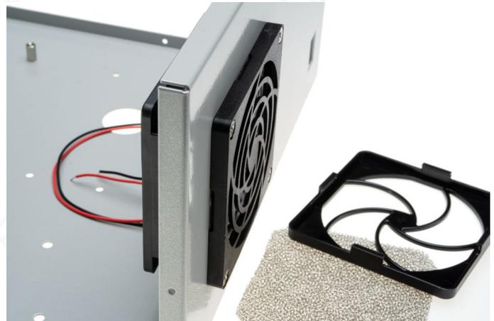
Bild 4: Lüfter an Gehäusefront, Kabel zum Boden weisend
