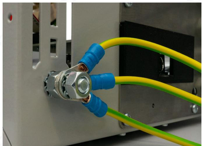
Bild 24: Erdungsverschraubung mit aufgelegten Kabeln
