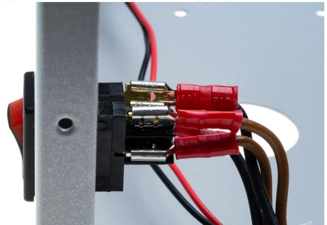
Bild 18: Links braun, rechts schwarz: Kabel an Hauptschalter
