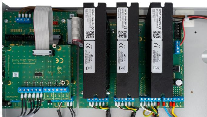
Bild 27: Aufgesteckte Endstufen
