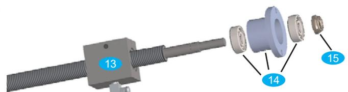
Bild 1: Zusammenbau der Kugelumlaufspindel
