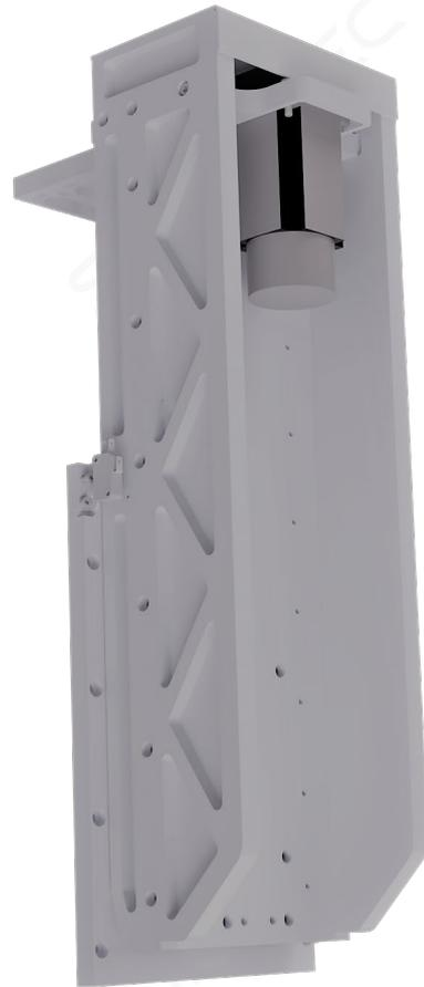
Bild 8: Die Z-Achse der Alu-Line als 3D-Zeichnung
