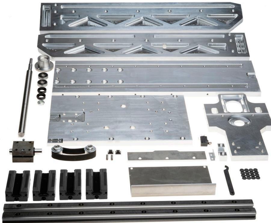
Bild 1: Der Bausatz Z-Achse 220 mm Alu-Line
