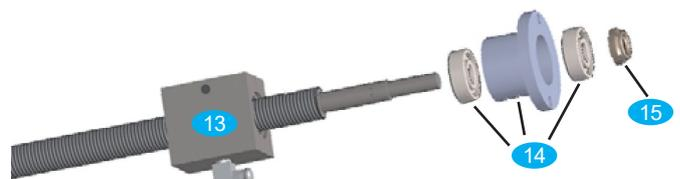
Bild 1: Zusammenbau der Kugelumlaufspindel
