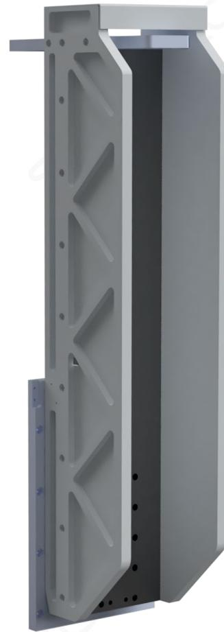
Bild 8: Die Z-Achse der Alu-Line als 3D-Zeichnung
