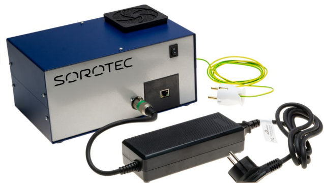
Bild 23: Fertig aufgebaute Mini-Steuerung mit Netzteil
