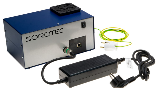
Bild 23: Fertig aufgebaute Steuerung C1 mit Netzteil
