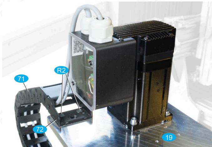
Bild 6: Montage Schleppkette an Motorflansch
